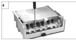
Schrauben Sie das Modul auf der Rückseite am Gehäuseunterteil des Hutschienenadapters fest. Material für die Befestigung liegt der Verpackung bei.
