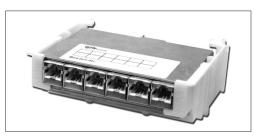
Nun kann der Hutschienenadapter mit dem integrierten Modul in einen entsprechenden Hutschienenverteiler eingebaut werden. Zur Beschriftung der Buchsen kann ein Aufkleber direkt am Modulgehäuse angebracht werden.
