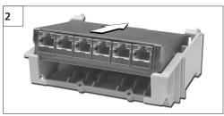
Schieben Sie nun das einzubauende Modul mit der Rückseite in einem flachen Winkel in das Gehäuseunterteil.
