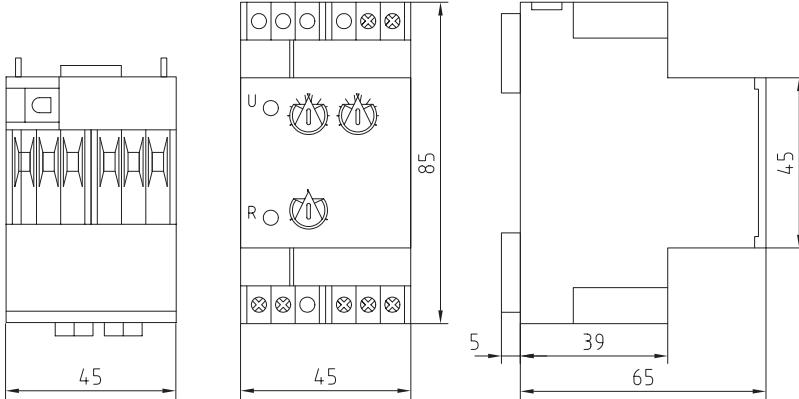
Elektronischer Hutschienenthermostat, Hutschienentemperaturregler **THERMASREG® TET** zum Einbau in Verteilungen oder Schaltschränken, mit schaltendem Ausgang und Mehrbereichsumschaltung und einstellbarer Hysterese. Geeignet zur elektronischen Regelung und Überwachung von Temperaturen mit Fernfühler, im Wohnbereich (z. B. in Fußbodenheizungen), in Hallen, Gewächshäusern und im Industriebereich. Der Regler verfügt über eine Fühlerbrucherkennung und Abschaltfunktion.
