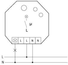
Für Einbaumontage. 45 mm lang, 45 mm breit, 33 mm tief. Versorgungs- und Schaltspannung 230 V. Beim Ausfall der Versorgungsspannung bleibt der Schaltzustand erhalten. Bei wiederkehrender Versorgungsspannung wird definiert ausgeschaltet. Nach der Installation die automatische kurze Synchronisation abwarten, bevor der geschaltete Verbraucher an das Netz gelegt wird.
