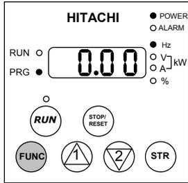
Wurde vor Netz-Aus eine der Anzeige- und Diagnosefunktionen d001 ... d090 angezeigt so wird nach Netz-Ein die Ausgangsfrequenz angezeigt. In allen anderen Fällen wird nach Netz-Ein die zuletzt angezeigte Funktion angezeigt
