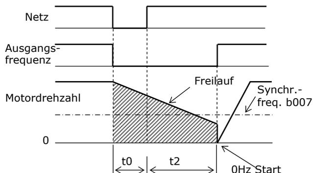
**Wenn die der Drehzahl des Motors entsprechende Frequenz niedriger ist als die hier programmierte Frequenz** wird der Motor auf 0Hz abgebremst und dann auf den Sollwert hochbeschleunigt (b001, 02)
