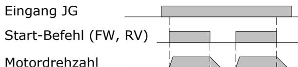
Der Tipp-Betrieb ist nicht möglich wenn die eingestellte Tipp-Frequenz kleiner ist als die unter Funktion b082 eingegebene Start-Frequenz.
