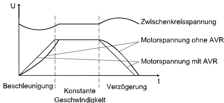
Wie in der obigen Darstellung zu erkennen ist, ruft der generatorische Motorbetrieb (ohne AVR-Funktion) in der Verzögerungsphase - insbesondere bei sehr kurzen Runterlaufzeiten - eine Anhebung der Zwischenkreisspannung hervor, die wiederum eine entsprechende Erhöhung der Motorspannung zur Folge hat. Diese höhere Motorspannung bewirkt eine Erhöhung des Bremsmoments. Aus diesem Grund kann z. B. unter Funktion A081 die AVR-Funktion für die Runterlaufphase inaktiviert werden.
