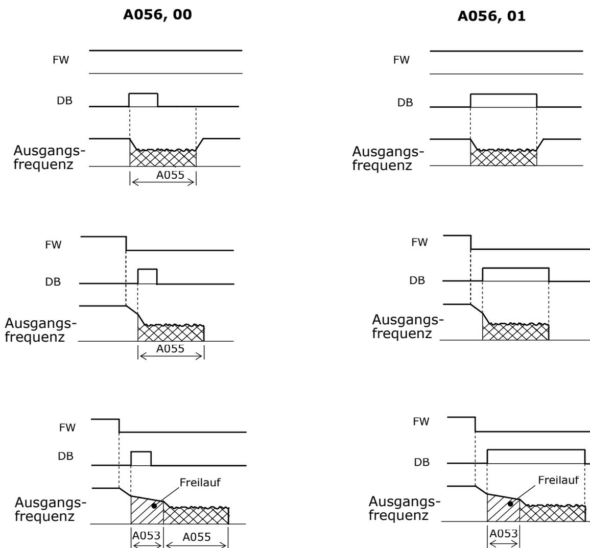
**Wird die DC-Bremse automatisch intern bei Erreichen einer programmierten Frequenz gestartet (A052), so haben die unter dieser Funktion eingegeben Parameter folgende Bedeutung:**
