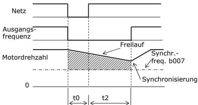
**Wenn die der Drehzahl des Motors entsprechende Frequenz höher ist als die hier programmierte Frequenz** synchronisiert sich der Frequenzumrichter auf die Motordrehzahl und beschleunigt auf den Sollwert (b001, 02)
