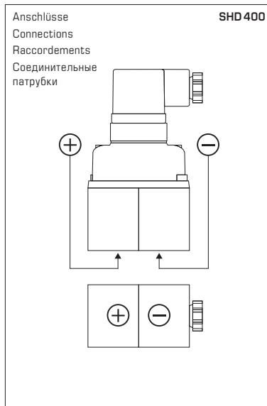
Ein am Gehäuse eingespritztes Plus- bzw. Minus-Symbole kennzeichnet die Seite, auf welcher der jeweilige Druckanschluss unten erfolgen muss:
