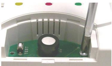
2 • Svitare le due viti di fissaggio del Modulo sensore da sostituire (Fig.12).
