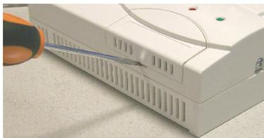
1 • Spegner il rivelatore scollegandolo dalla rete di alimentazione e con l'aiuto di un cacciavite fare leva nell'apposita fessura per rimuovere il coperchietto posto sotto i tre LED.
