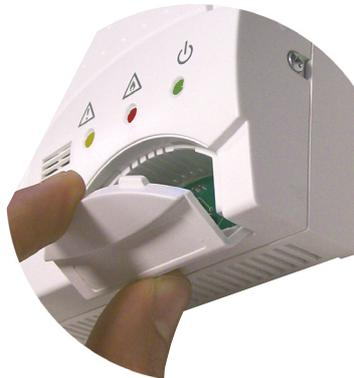
5 • Fissare il Modulo sensore tramite le due viti e chiudere il coperchietto inserendo prima i due perni inferiori. (Fig.15).
