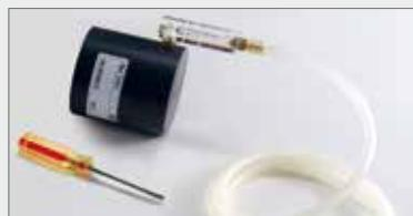
Si eroga gas tramite il Kit di calibrazione collegato alla bombola di gas campione.
